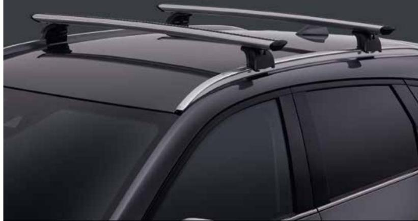
Дуги багажника на крышу (поперечные)
